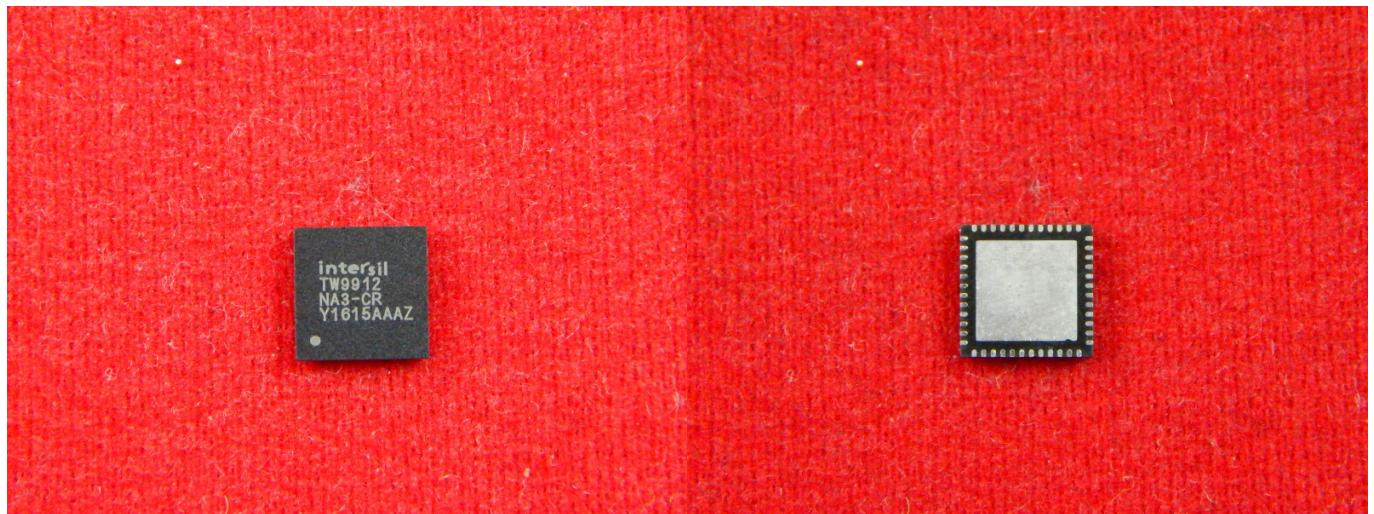
Видеодекодер - это электронная схема, часто содержащаяся в одном кристалле интегральной схемы, которая преобразует аналоговые видеосигналы базового диапазона в цифровое видео.
