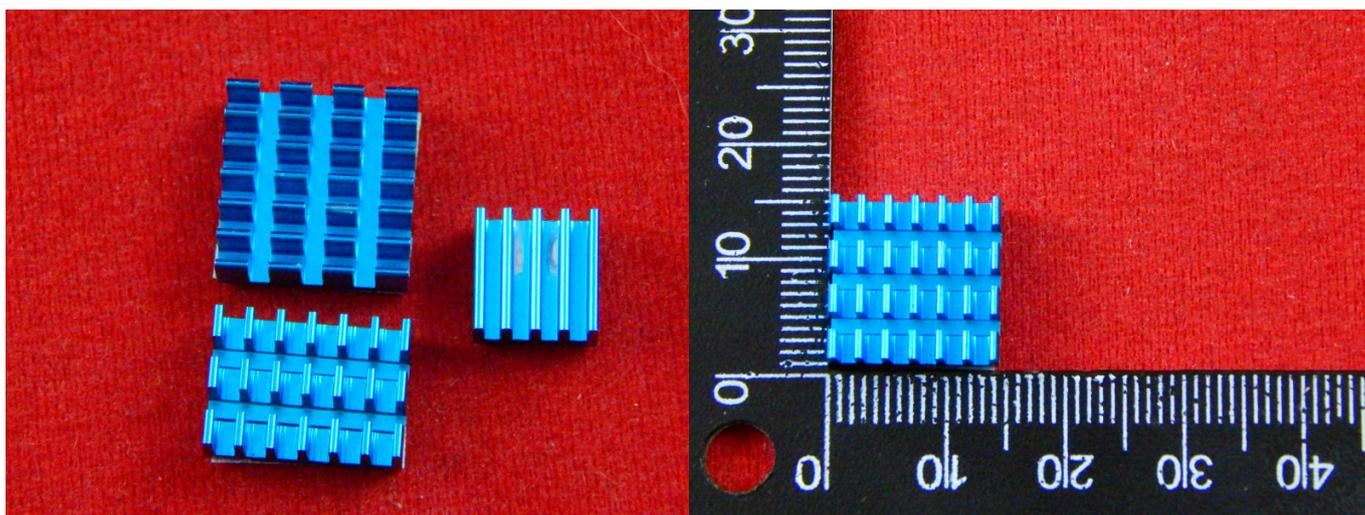
Радиатор отлично отводит тепло, в десятки раз продлевая функционирование электроники - светодиодной техники, микросхем, транзисторов, процессоров и так далее. Отсутствие радиатора может привести к выходу техники из строя раньше времени.
