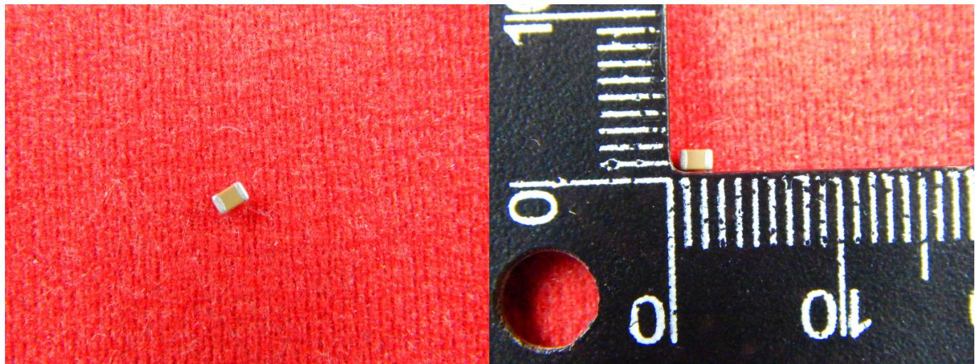
Керамические чип конденсаторы предназначены для автоматизированного поверхностного монтажа на печатные платы с последующей пайкой оплавлением, горячим воздухом или в инфракрасных печах. Идеален для высокоплотного монтажа. Используются в электрических цепях постоянного, переменного токов и в импульсных режимах.
