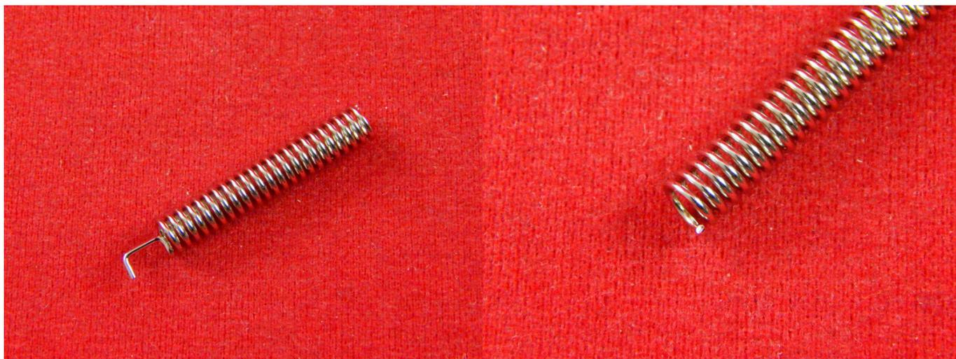
Спиральная антенна — диапазонная антенна бегущей волны, основным элементом которой является проводник в форме винтовой линии или спирали. Характерной особенностью спиральных антенн является их высокое входное сопротивление. Применяется антенна, как правило, для приёма и передачи на высоких частотах.
