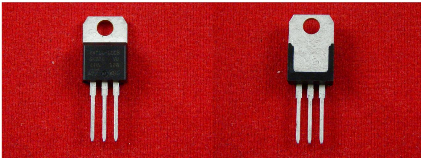
ВАТ16-600В - симисторы (симметричные тиристоры) средней мощности в корпусе ТО-220. Фланец корпуса симистора серии ВАТ изолирован от остальных выводов. Является аналогом [ВАТ16-600В](#).
