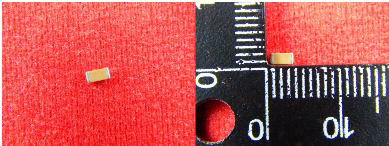
Керамические чип конденсаторы предназначены для автоматизированного поверхностного монтажа на печатные платы с последующей пайкой оплавлением, горячим воздухом или в инфракрасных печах. Используются в электрических цепях постоянного, переменного токов и в импульсных режимах.
