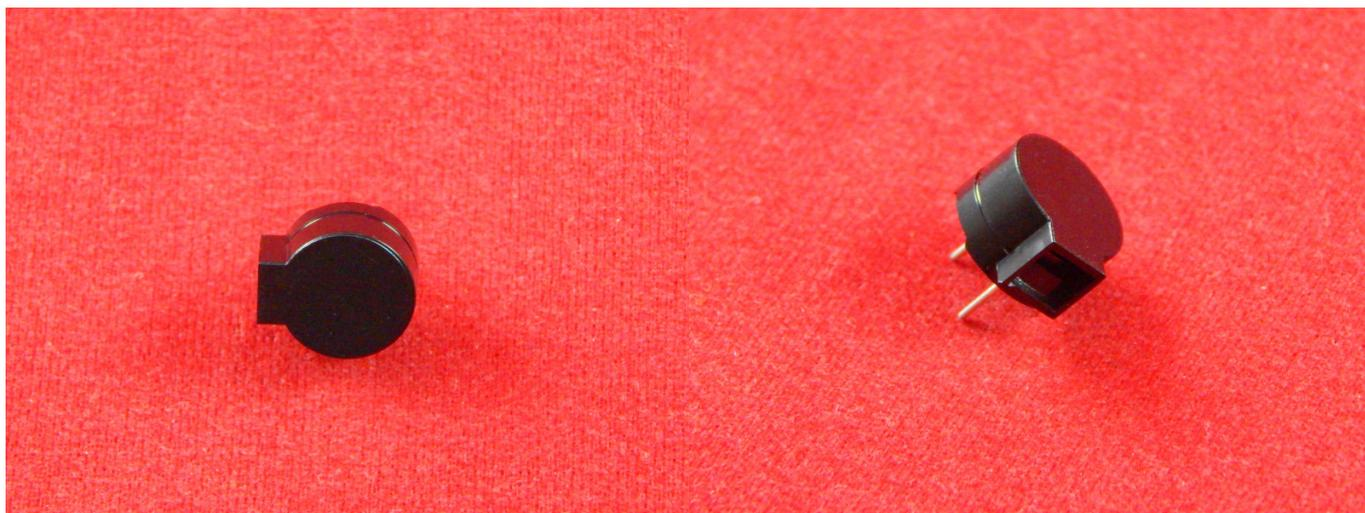
Зуммер - это электро-механическое, электронное или пьезоэлектрическое устройство, используемое в электротехнике, радиотехнике и телефонии для подачи звукового сигнала.
