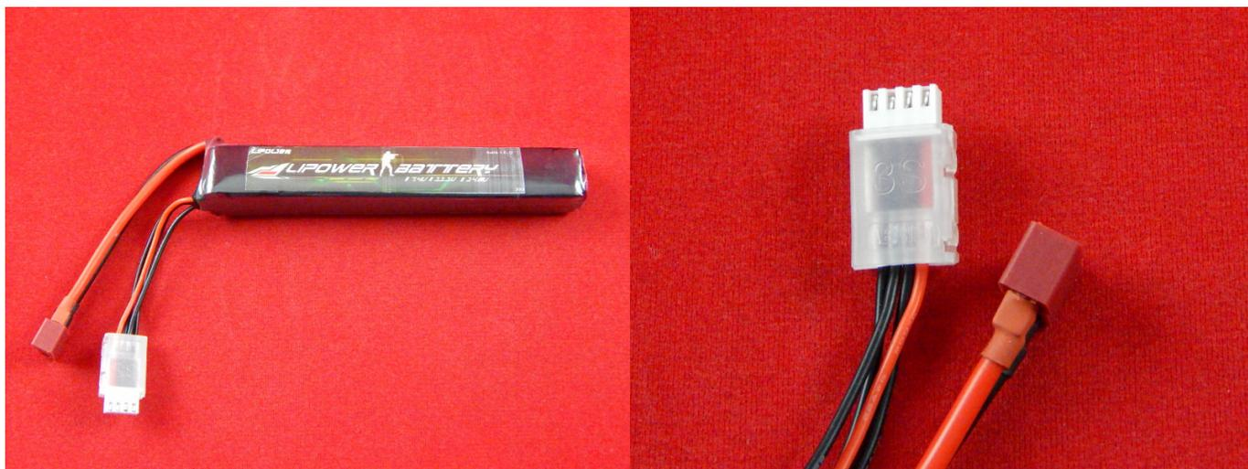
Литий-полимерный аккумулятор — это усовершенствованная конструкция литий-ионного аккумулятора. В качестве электролита используется полимерный материал.
