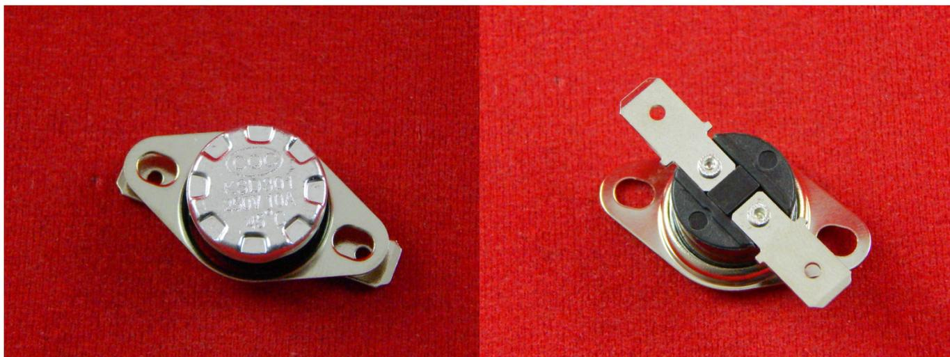
Термостаты биметаллические с нормально закрытыми контактами предназначены для размыкания электрической цепи при достижении определенной температуры. Используется в бытовой технике для экстренного отключения при перегреве. При остывании возвращается в первоначальное состояние. Служит для защиты электрооборудования от перегрева.
