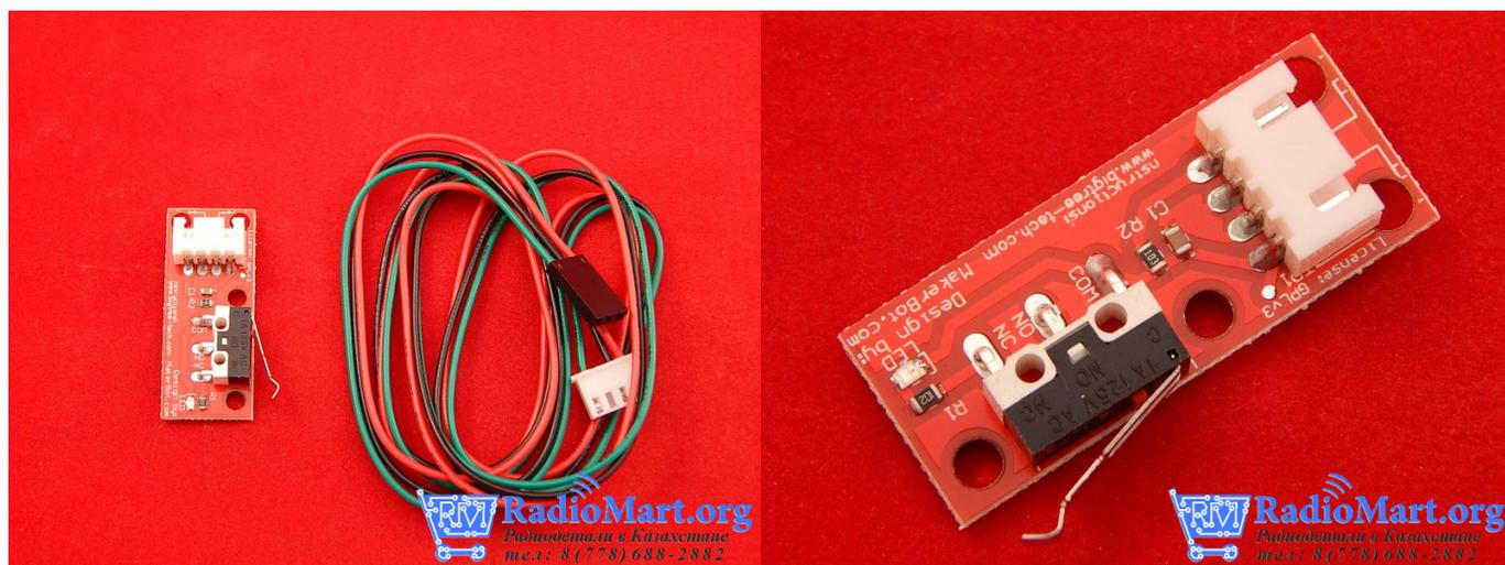
Механический EndStop для RAMPS 1.4 на 3d принтер представляет собой концевой микровыключатель распаянный на плате вместе с LED индикационными диодами и разъёмом для удобства подключения.
