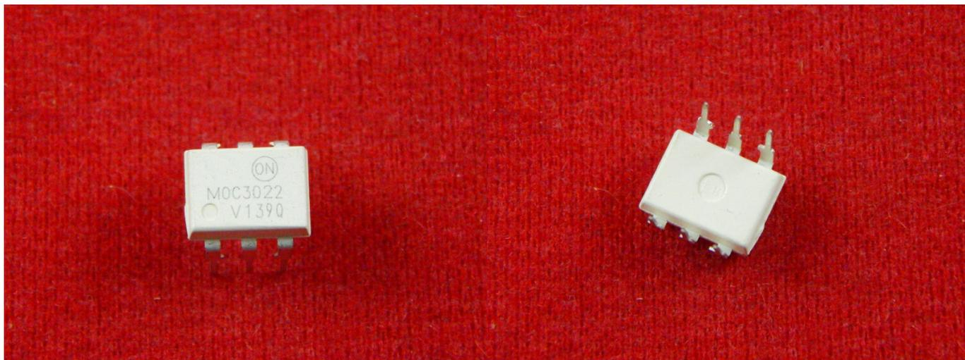
Оптрон — оптоэлектронный прибор, главными функциональными частями которого выступают источник света и фотоприемник, гальванически не связанные друг с другом, но расположенные внутри общего герметичного корпуса.
