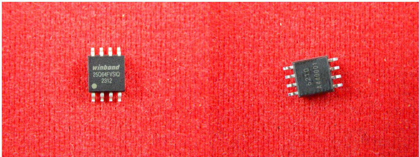
Интегральная микросхема - это совокупность электрически связанных компонентов (транзисторов, диодов, резисторов и другого), изготовленных в едином технологическом цикле на единой полупроводниковой основе (подложке).
