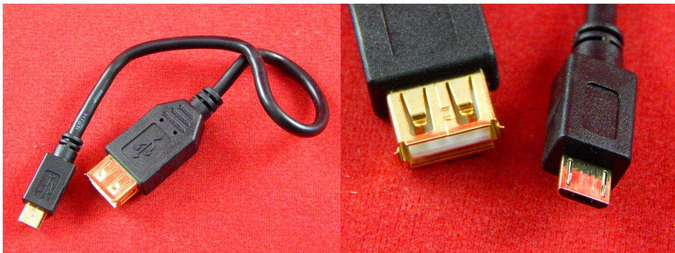
Данный кабель Micro-USB используется для соединения мультимедийных устройств с компьютерным и зарядным устройством.
