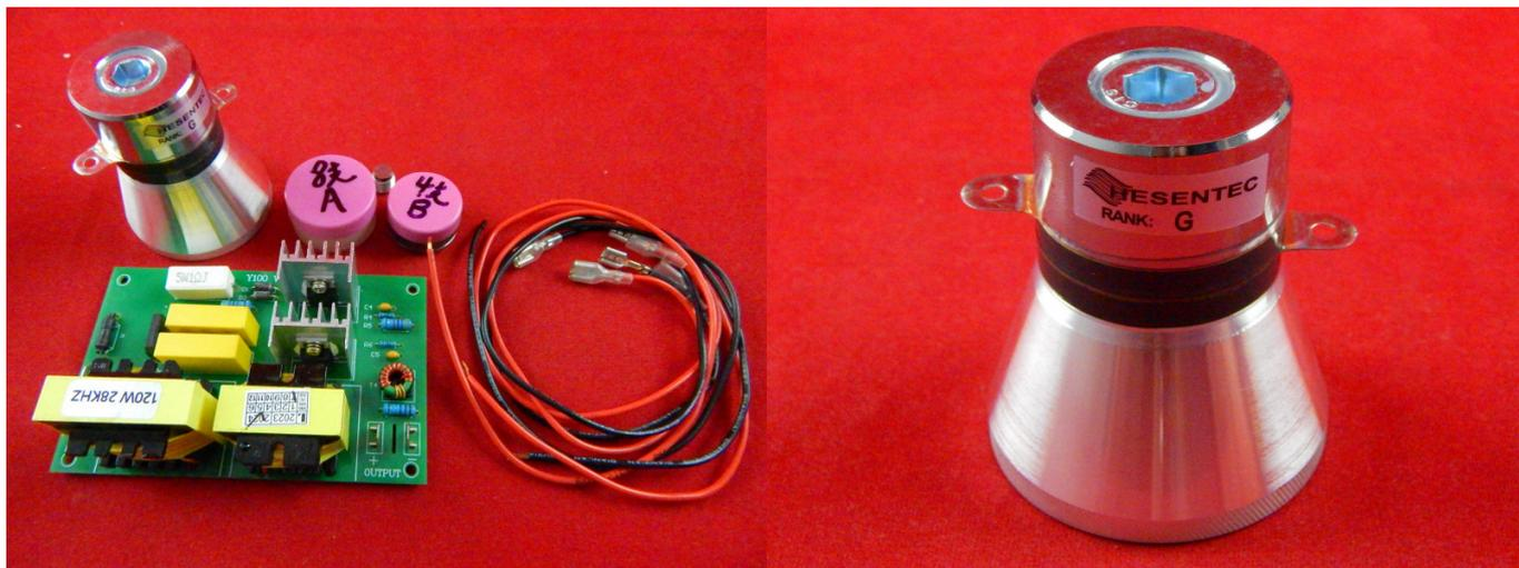
Плата драйвер переменного тока 220В, 100Вт с датчиком ультразвуковой очистки 60Вт, 28кГц. Применимо к: маломощной ультразвуковой очистительной машине, бытовой очистительной машине, ультразвуковой генераторной машине.
