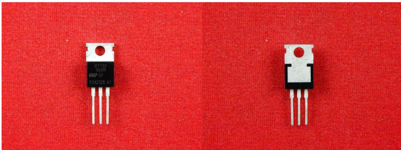
Тиристоры - это полупроводниковые приборы с тремя или более p-n-переходами. Тиристор проводит ток только в одном направлении, и имеет два устойчивых состояния открытое и закрытое.
