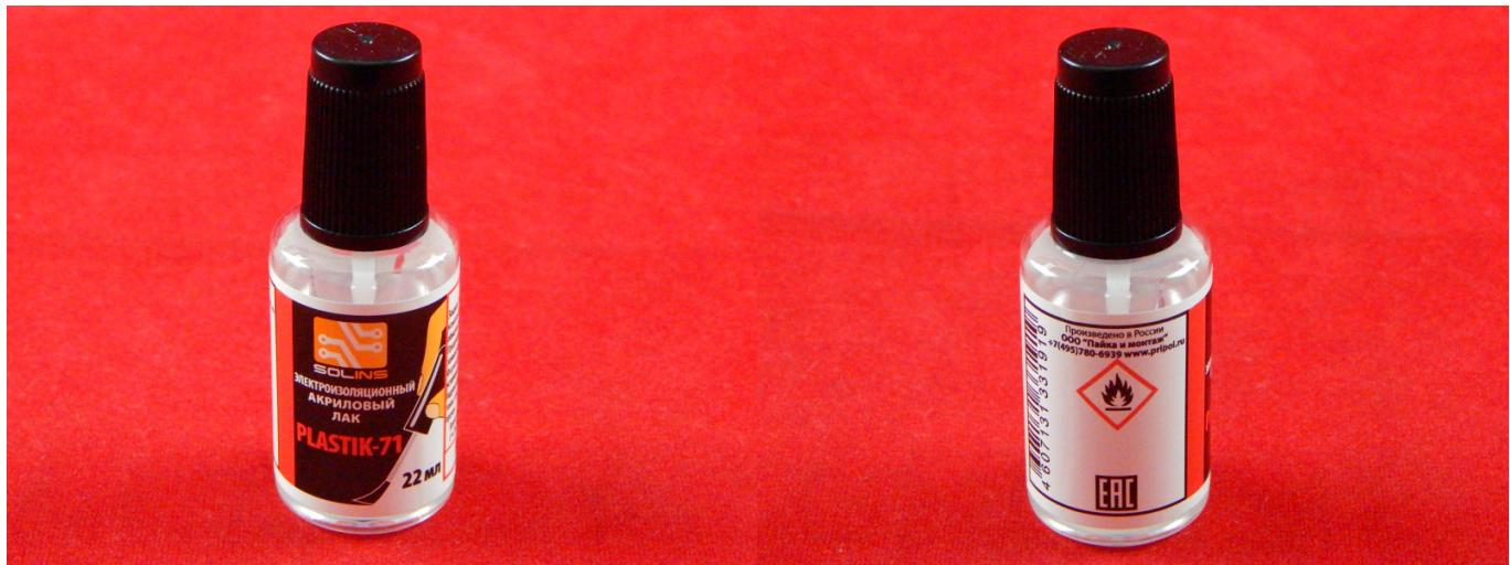
Изготовлен на основе акриловой смолы, идеально удовлетворяет требованиям микроэлектроники. Лак содержит флуоресцирующую добавку для контроля равномерности (сплошности) нанесения пленки лака на поверхность печатной платы. Контроль осуществляется освещением платы ультрафиолетовыми лампами. Так называемыми «лампами черного света» (Black light).
