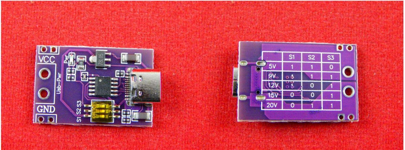
PD/QC/AFC триггер быстрой зарядки Type-C позволяет получить любое напряжение от зарядного устройства по протоколам Power Delivery PD2.0/PD3.0, Quick Charge QC2.0/QC3.0, AFC, благодаря возможности выбора запрашиваемого протокола с помощью переключателя.
