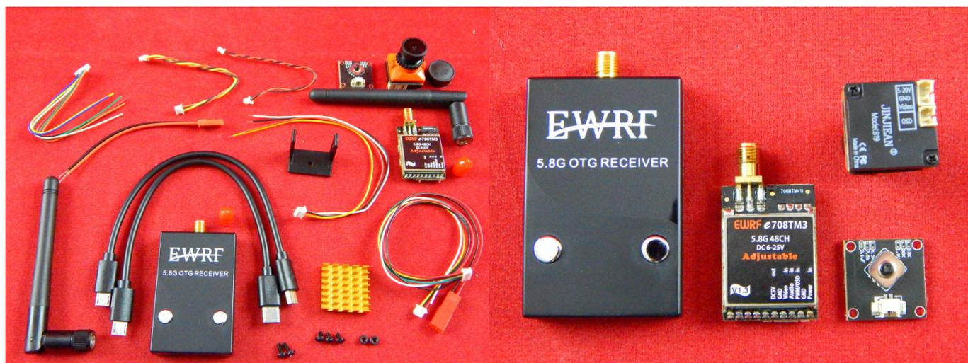
OTG 5.8G FPV приемник. Позволяет получить картинку с FPV камеры на экран вашего android смартфона или планшета. С минимальными задержками. Самый бюджетный и компактный вариант полноценной FPV системы. Улучшенная версия приемника.
