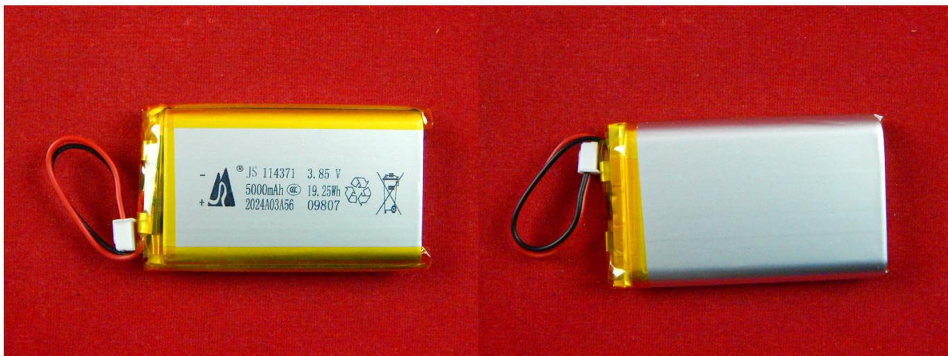
Аккумулятор литий полимерный (Li-Pol) 5000мА/ч 3.85В - для использования в схемах резервного питания; медицинском оборудовании; мобильных электронных устройствах; мобильных телефонах; компьютерной технике; специальной технике.
