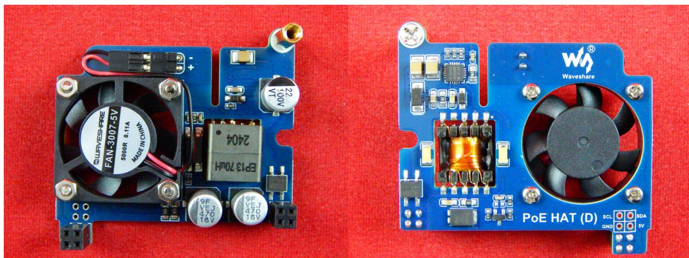
PoE HAT (D) адаптер для Raspberry Pi 3B+/4B совместимый со стандартом 802.3af и обеспечивает питания микрокомпьютера и подключение к сети посредством порта RJ-45. Использует полностью изолированный импульсный источник питания 5В, 2.5А.
