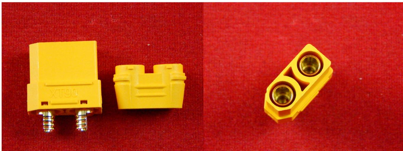
Разъем XT90 сделан из высокотемпературного нейлона с позолоченными пружинными контактами, которые были установлены в пресс-форму в момент литья и формирования разъема. Можно использовать на любых видах моделей. Отличная замена для разъемов EC5.
