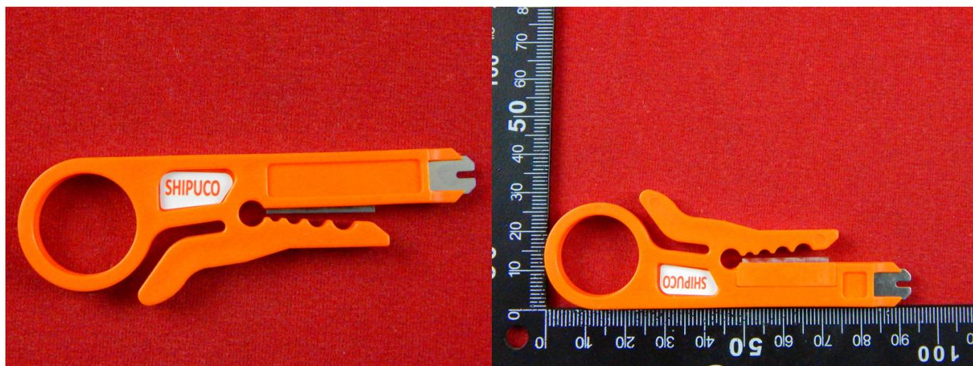
Стриппер — электромонтажный инструмент, предназначенный для удаления изоляции с концов проводов или разделки кабеля при электромонтажных работах.
