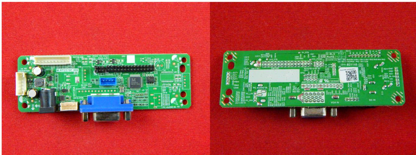
Данный контроллер ЖК-дисплея с адаптером VGA для LVDS М. RT2270C.806 представляет собой плату управления монитором с разрешением до 1920×1080 при 60 Гц.
