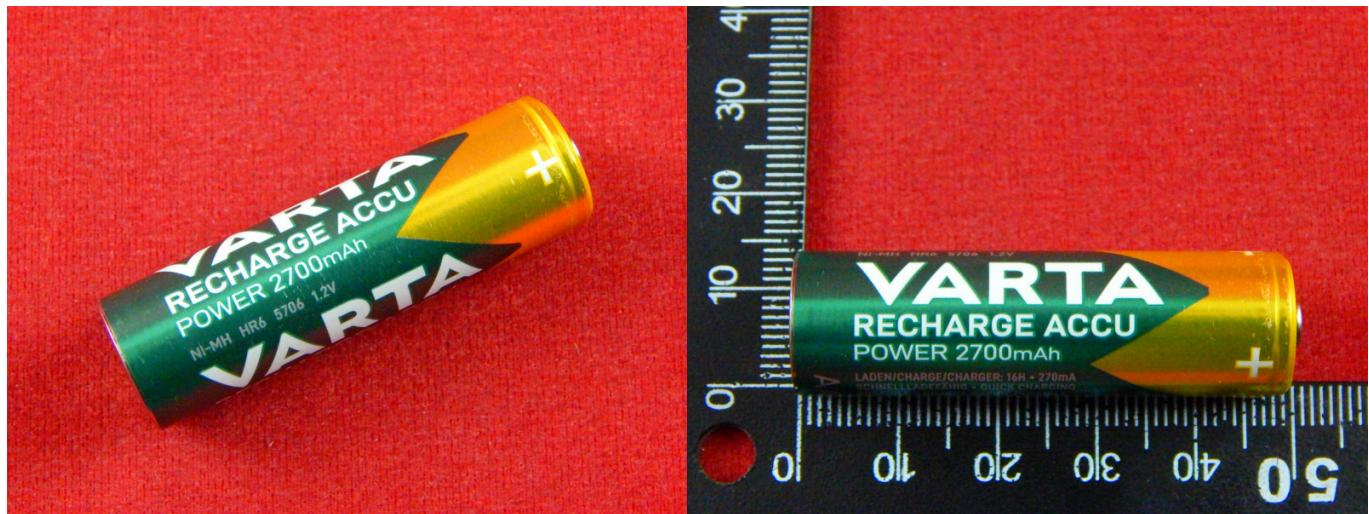
Низкотемпературные Ni-Mh (никель-металлгидридный) аккумулятор AA, 2700 мА·ч, 1.2В. Предназначены для использования в фотоаппаратах, рациях, CD/MP3 плеерах, фонарях, игрушках и так далее.
