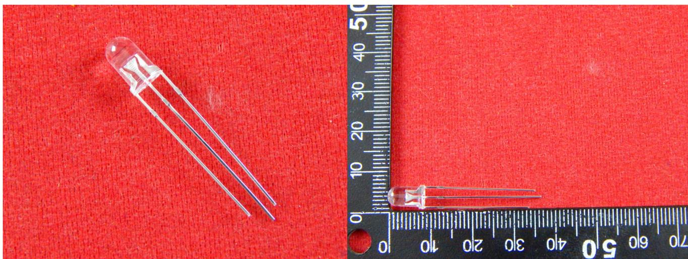
Двухцветный светодиод - универсальный способ индикации, с помощью которого можно отобразить гамму из множества цветов (смеси красного и зелёного) для максимально точной передачи состояния устройства.
