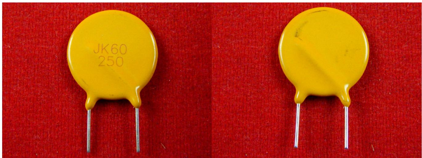
Предохранитель самовосстанавливающийся - применяется для защиты электронной аппаратуры. Принцип действия основан на резком увеличении сопротивления при превышении порогового тока, протекающего через него.
