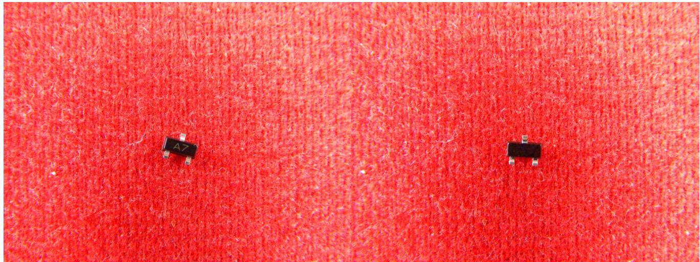
BAV99 - сборка из двух выпрямительных диодов выполненная в корпусе для SMD монтажа. Основное преимущество которого - высокое быстродействие и низкая емкость перехода. Аналоги BAV99LT1G, CH228K, включая отечественный КД707АС9.
