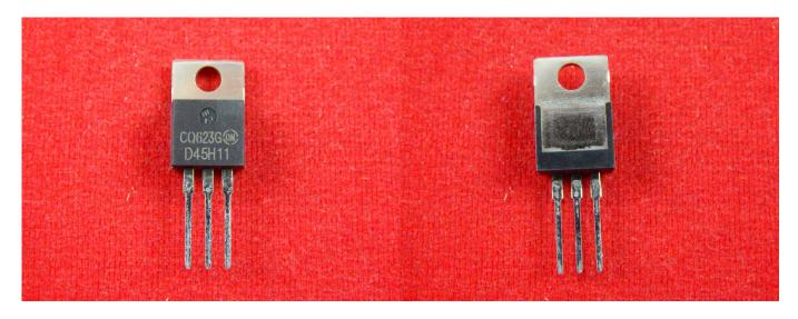
Транзистор - полупроводниковый элемент с тремя выводами (обычно), на один из которых (коллектор) подаётся сильный ток, а на другой (база) подаётся слабый (управляющий ток).
