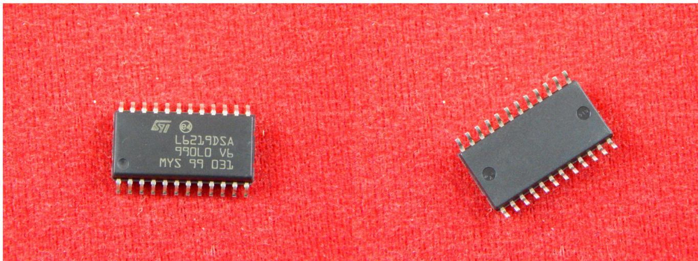
E-L6219DSATR - это биполярная монокристаллическая интегральная схема, предназначенная для управления обеими обмотками биполярного шагового двигателя или двунаправленного управления двумя двигателями постоянного тока.
