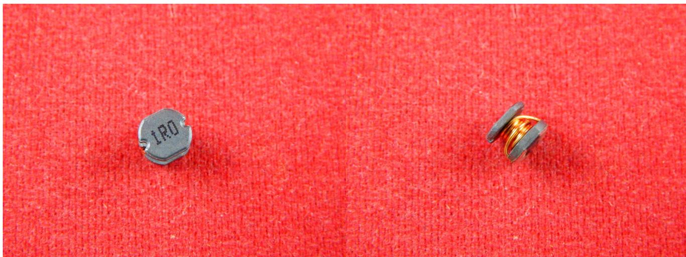
SMD индуктивность CD54 (5.8x5.2x4.5 мм) – это электронные радиокомпоненты для поверхностного монтажа на печатную плату, которые имеют определённую индуктивность при малой ёмкости и небольшом активном сопротивлении.
