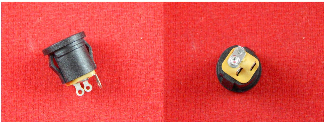
Разъём DC-022K 5.5×2.5 разработан для подачи напряжения на устройство, имеет удобное крепление к корпусу, небольшие размеры, выдерживает максимальное напряжение 30В и способен пропускать ток до 0.5А.
