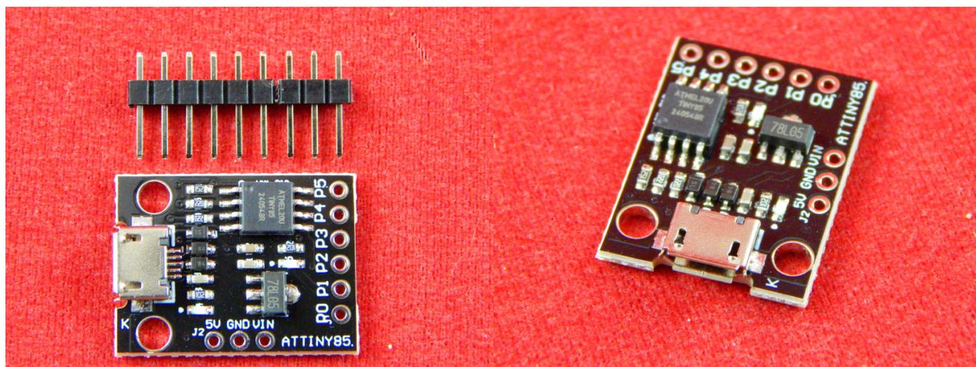
Attiny85 – принципиально новый продукт в среде прототипирования устройств на Arduino. Attiny85 — это именно та плата, которая идеально подходит для многих маленьких устройств, где полноценные Arduino-совместимые платы использовать нерационально.
