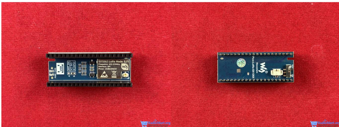
Модуль **Pico LoRa SX1262-433M** обеспечивает дальнюю радиосвязь по технологии **LoRa / LoRaWAN** на частоте **433 МГц**. Создан на базе чипа **Semtech SX1262** и подключается к **Raspberry Pi Pico / Pico W** через интерфейс **SPI**. Обеспечивает передачу данных на расстояние до **5 км**, поддерживает низкое энергопотребление и простую интеграцию в IoT-системы.
