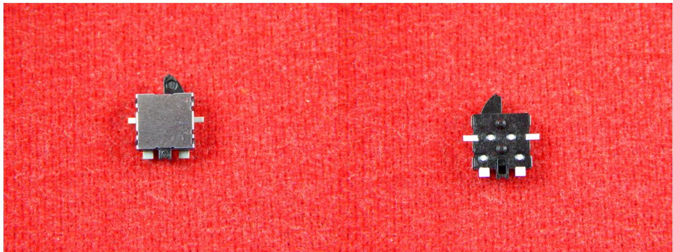
Микропереключатели – малогабаритные устройства, которые коммутируют цепи переменного и постоянного тока в электронных и радиотехнических устройствах.
