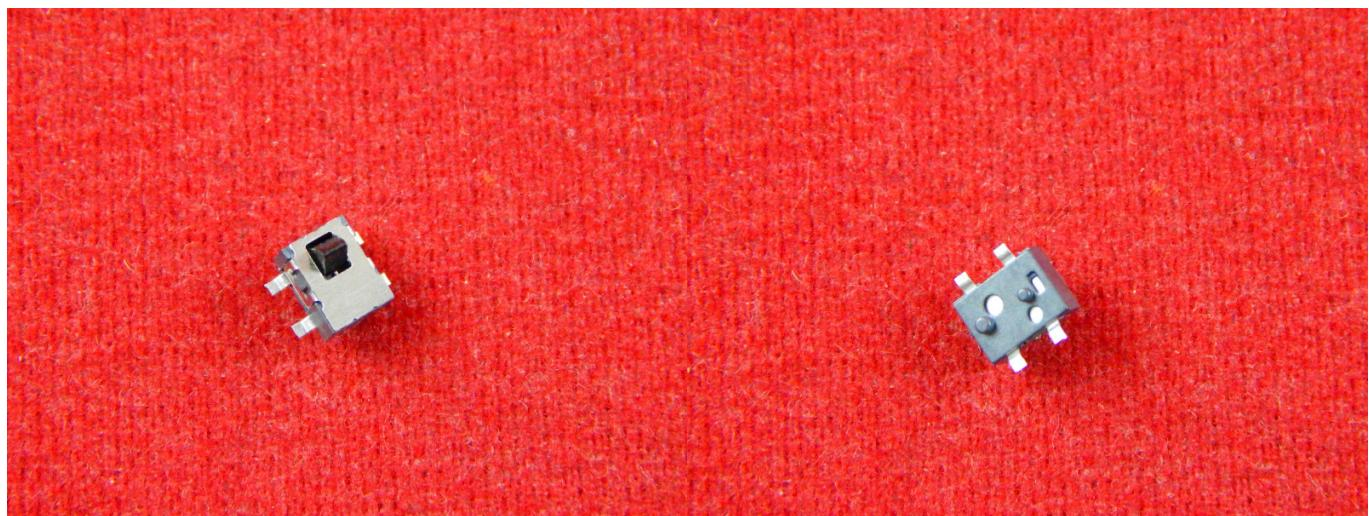
Микропереключатель обнаружения — это небольшой переключатель, предназначенный для определения присутствия или отсутствия объекта.
