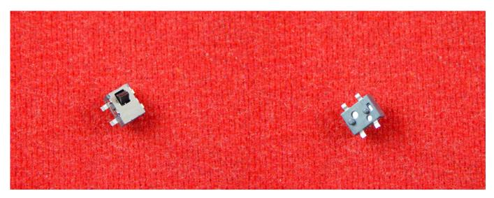
Микропереключатель обнаружения — это небольшой переключатель, предназначенный для определения присутствия или отсутствия объекта.
