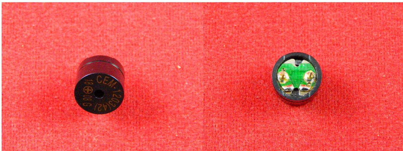
Зуммер - простейшее устройство для создания звукового сигнала. Данное устройство воспроизводит звуки на частоте 2.048 кГц.
