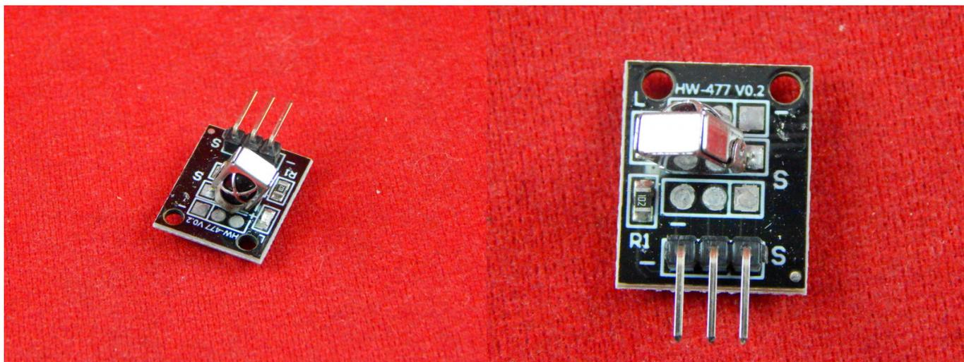
Данный ИК-датчик воспринимает инфракрасный сигнал на частоте 38 кГц. На этой частоте работает большинство бытовых ИК-пультов.
