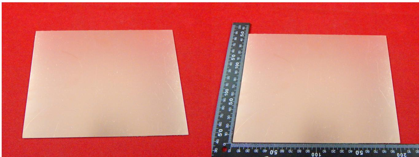
Печатная плата двухсторонняя 15x20см (Стеклотекстолит FR-4 1мм) предназначена для электрического и механического соединения различных электронных компонентов. Электронные компоненты на печатной плате соединяются своими выводами с элементами проводящего рисунка обычно пайкой.
