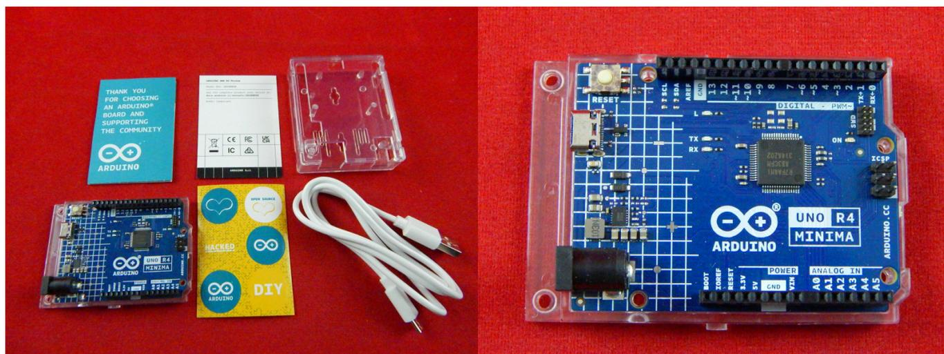
Aduino Uno R4 Minima представляет собой эволюцию классической платы разработки Arduino Uno, модернизирующей 8-разрядный микроконтроллер AVR до 32-разрядного Arm Cortex-M4 с сохранением того же форм-фактора. Это позволяет повысить производительность и объем памяти в знакомом корпусе, совместимом с существующими экранами и аксессуарами Arduino.
