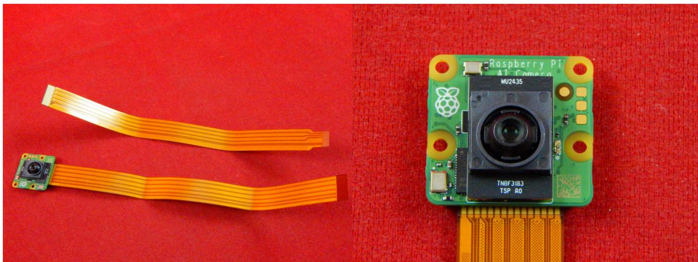
Raspberry Pi AI Camera — это компактный модуль камеры от Raspberry, основанный на интеллектуальном сенсоре Sony IMX500. IMX500 сочетает в себе 12-мегапиксельный CMOS-датчик изображения с встроенным ускорителем инференса для различных популярных нейросетевых моделей, позволяя пользователям разрабатывать сложные AI-приложения на основе компьютерного зрения без необходимости в отдельном ускорителе.
