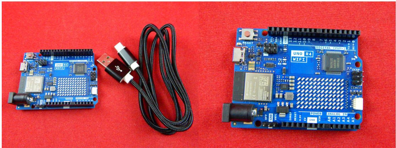
UNO R4 - одна из наиболее популярнейших плат из серии duino. Является отличным вариантом для разработки электронных проектов, требующих беспроводного подключения. Она сочетает простоту использования и расширенные возможности Arduino Uno с возможностью беспроводной связи, что открывает дополнительные возможности для взаимодействия и сбор данных из разных источников.
