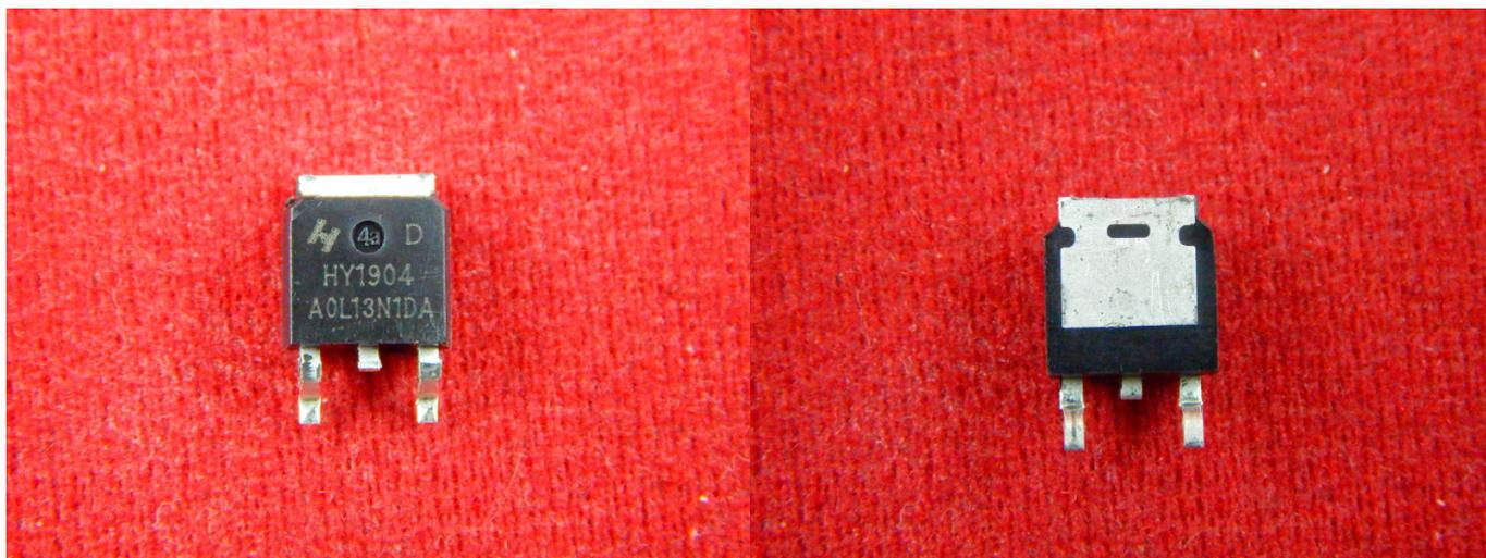
Полевой транзистор — полупроводниковый прибор, принцип действия которого основан на управлении электрическим сопротивлением токопроводящего канала поперечным электрическим полем, создаваемым приложенным к затвору напряжением.
