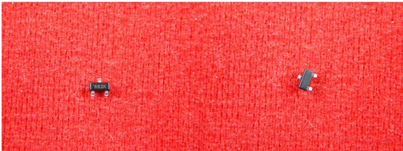
XC6206 – это серия малошумящих линейных стабилизаторов напряжения (LDO) с низким энергопотреблением, предназначенных для питания микроконтроллеров и других электронных компонентов.
