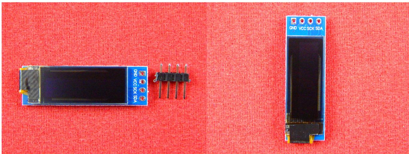
0.91" OLED дисплей с синим свечением символов, а также поддержкой интерфейса I2C. Разрешение 128x32 пикселя. Драйвер SSD1306.
