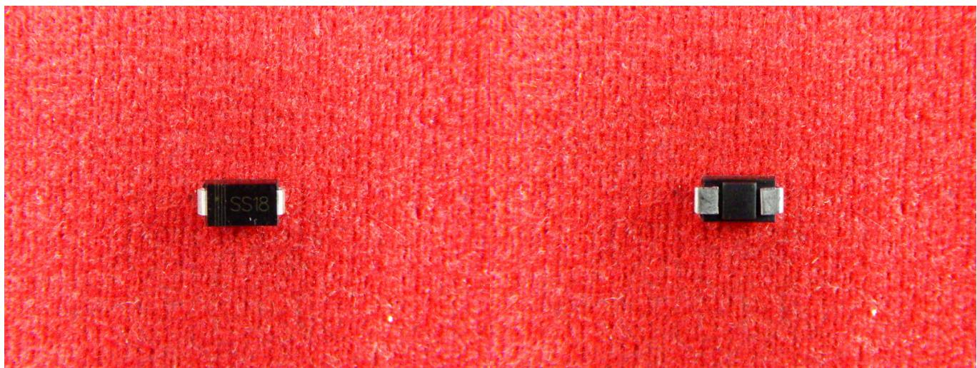
Диод SS18 выпрямительный с барьером Шоттки. Предназначен для применения в быстродействующих импульсных устройствах с максимально допустимый средним прямым током 1А. На корпусе DO-214AC (SMA) со стороны катодного вывода нанесена полоска.
