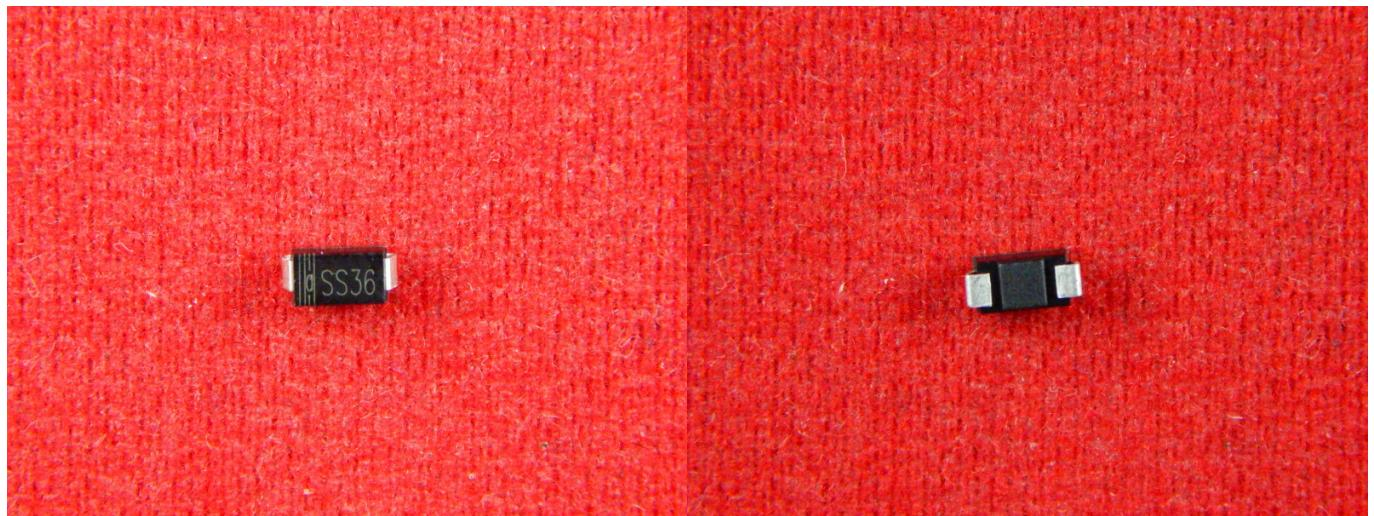
Диод Шоттки SS36 60В, 3А, полупроводниковый диод с малым падением напряжения при прямом пропускании тока.
