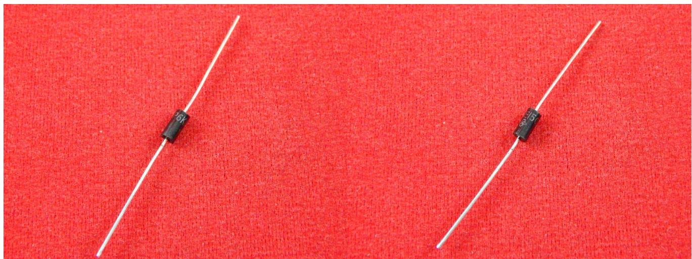
Защитный двунаправленный диод P6KE15CA обеспечивает высокую защиту от перенапряжения. Диод предназначен для защиты чувствительного электронного оборудования от переходных процессов напряжения вызванных молнией и другими событиями переходного напряжения. На корпусе со стороны катодного вывода нанесена кольцевые метка.
