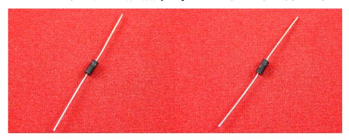
Защитный двунаправленный диод P6KE15CA обеспечивает высокую защиту от перенапряжения. Диод предназначен для защиты чувствительного электронного оборудования от переходных процессов напряжения вызванных молнией и другими событиями переходного напряжения. На корпусе со стороны катодного вывода нанесена кольцевые метка.
