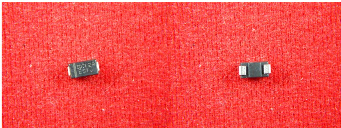
ES1J — это быстродействующий выпрямительный диод, предназначенный для применения в импульсных источниках питания, преобразователях и других схемах, где требуется высокая скорость переключения и устойчивость к напряжению.
