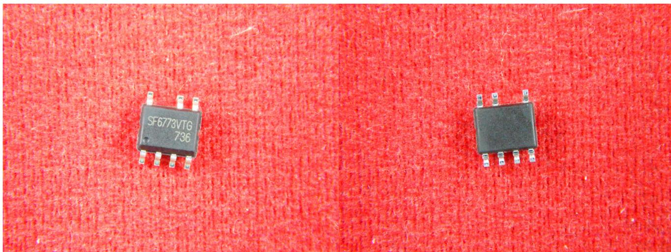
SF6773VTG — это интегральная схема управления питанием. Она предназначена для использования в источниках питания с первичной регулировкой и встроенным силовым MOSFET-транзистором на 650В. Корпус микросхемы — SOP-7.
