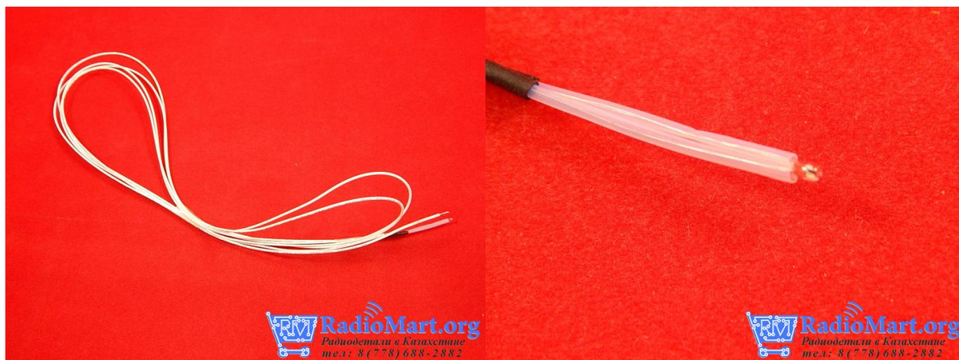
Датчик температуры для экструдера 3D принтера с кабелем 1м. Из-за очень большого изменения сопротивления датчик рекомендуется применять в задачах, в которых диапазон измерения не более чем 50-100 градусов (т.е., например, от 200°C до 280°C).
